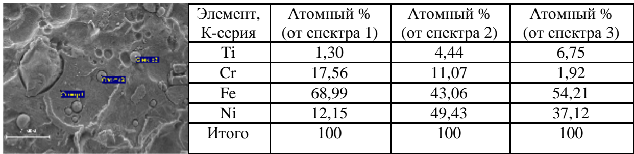
а) б) Рис. 12 – а) Электронно-микроскопическое изображение поверхности нержавеющей стали JSM-6390LV; б) Расшифровка спектров 1, 2, 3
