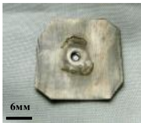
Рис. 2 - Фотография образца Ni-Ti после реакции
