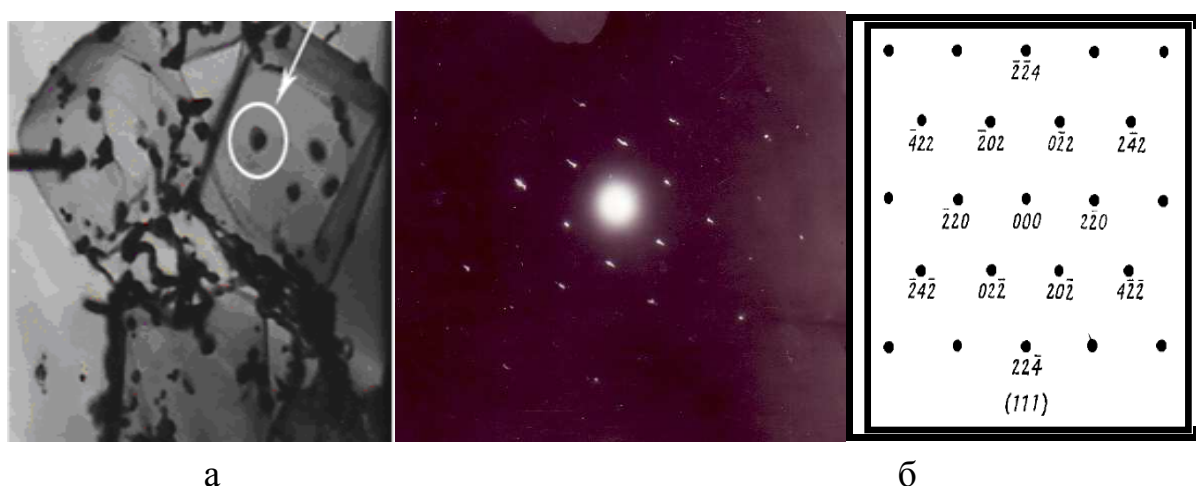
Рис. 4. а) Микрофотография угольной реплики исходных МК AgBr (111), d=1 мкм, после засветки и восстановления в растворе 1:100 УП-2 (t вос = 3 мин.). Увеличение 70000; б) микродифракция от наночастиц серебра на поверхности образца (а).
